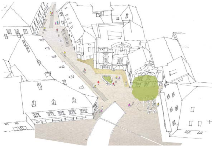
Abb.132 a. (v.l.n.r.) Entwurfsperspektive, Übersicht über eine mögliche Anbindung der Kirchengasse an die bestehende Hauptplatzgestaltung sowie die Einbindung der Steingasse. Der homogene Straßenraum wird durch die Ausbildung eines 'Catwalks' in der Straßenmitte modifiziert; in besonderen Bereichen wie Terrassen vor gastronomischen Betrieben werden großzügige Pflasterungen wie 'Vorteppiche' ausgebildet. (Bild: AAPS)
